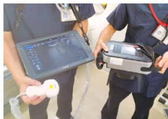
ポータブルX線機器式 コンパクトな本体、 モバイルPC、パネル。
